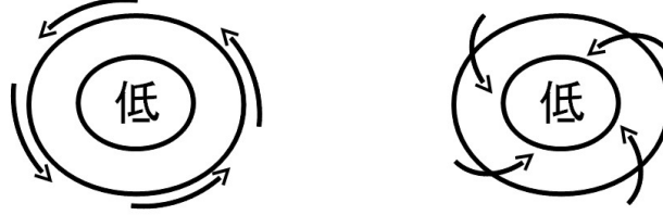
低気圧のまわりの風の模式図（左：摩擦がない場合、右：摩擦がある場合）
